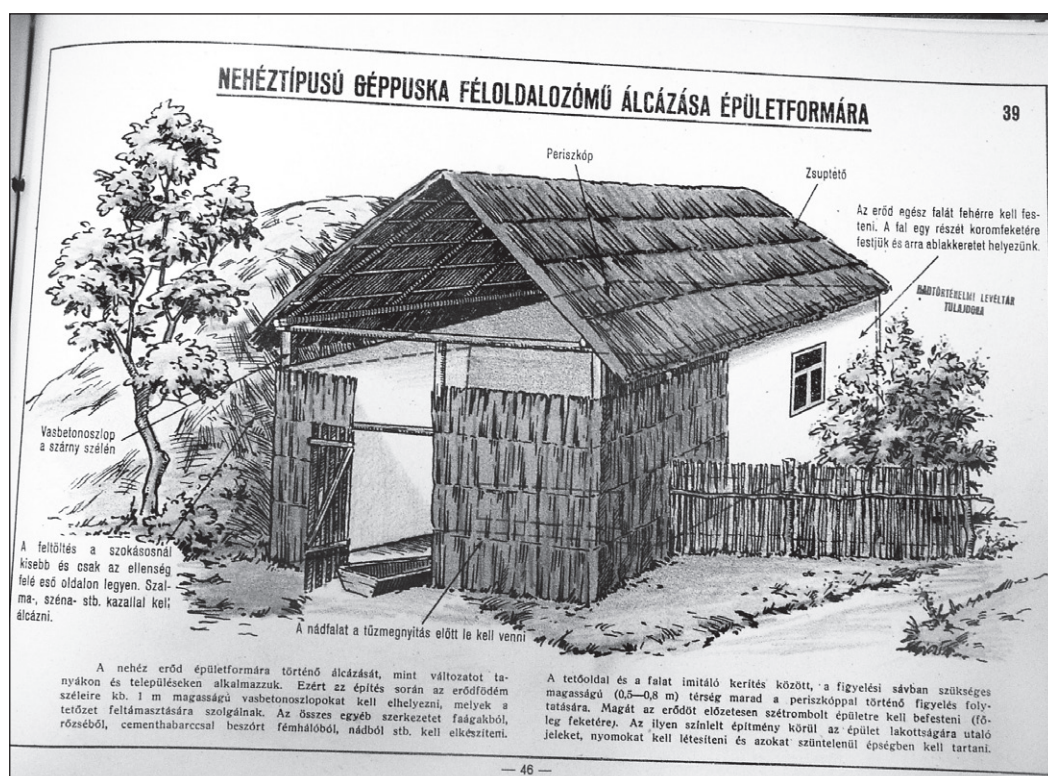
12. ábra: Nehéztípusú géppuska féloldalozómű álcázása épületformára (Forrás: szerző felvétele, Hadtörténeti Levéltár Bp.)
